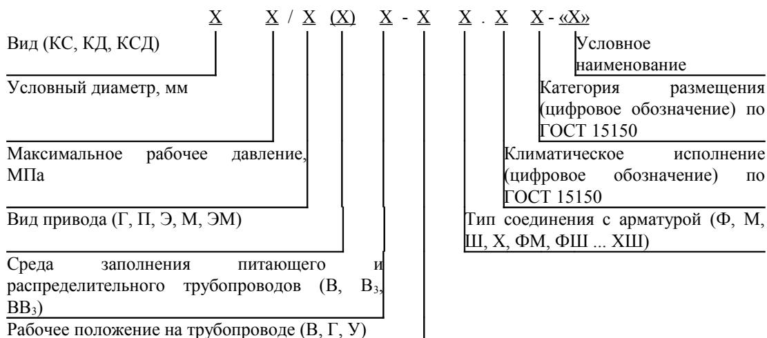
Примечания. 1. В обозначении спринклерных клапанов тип привода не проставляют.
